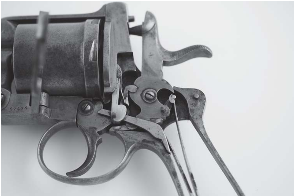
Fig. 4 - Rivoltella Gasser basculante M. 1877, meccanismi interni. Particolare dell'aggancio molla-cane (MGR, foto M. Leonardi)
