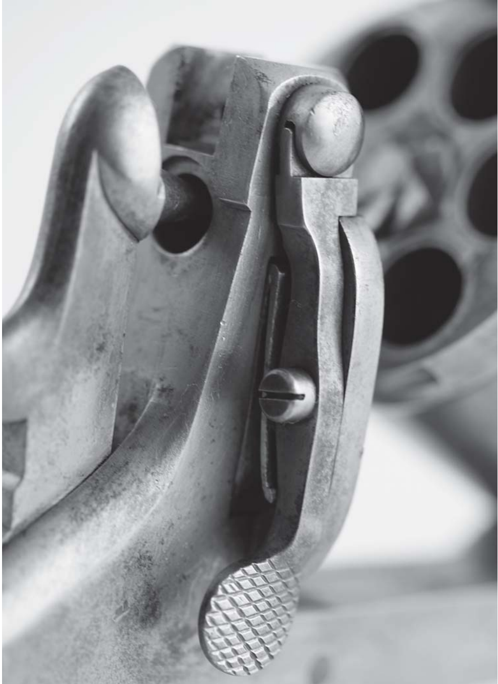
Fig. 5 - Rivoltella Gasser basculante M. 1877, leva e piolo di apertura-chiusura (MGR, foto M. Leonardi)
