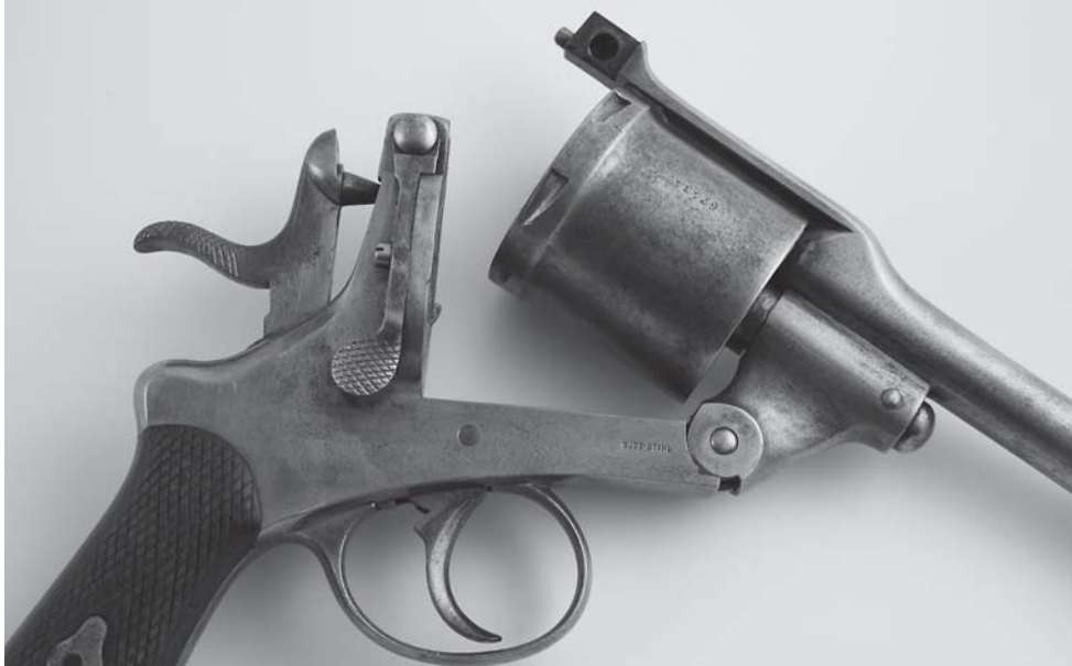
Fig. 3 - Rivoltella Gasser basculante M. 1877, aperta (MGR, foto M. Leonardi)
