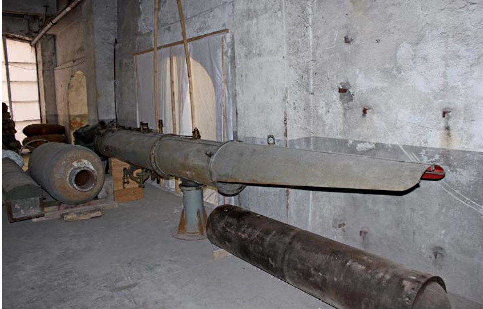
Fig. 6 - Il tubo lanciasiluri appartenuto alla torpediniera austro-ungarica 67 (ex 67 F, ex Phoenix ) conservato al Museo Guerra [foto: Nicola Ragnoli].
