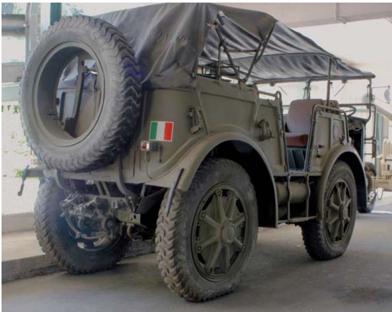
Fig. 7-8 - Vista di 3/4 anteriore e posteriore del TM40 dalle quali si può apprezzare la solidità e anche la bellezza del mezzo originario; si noti la ruota di scorta montata sul supporto ribaltabile, sistema comune al TM40 e al TL37. La nuova targa testimonia la sua immissione in servizio nell'Esercito italiano dopo la guerra.
