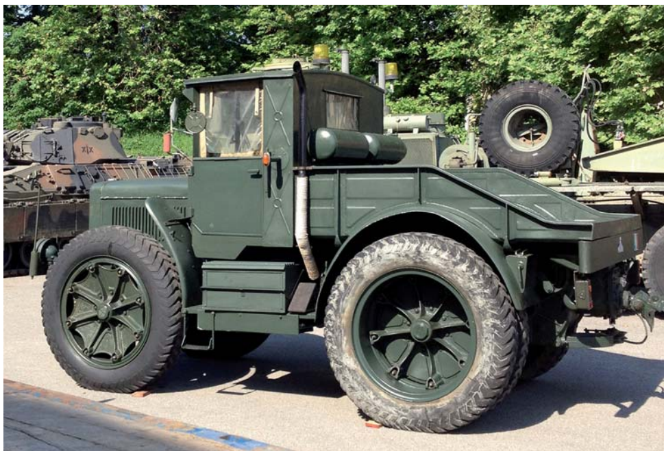
Fig. 2 - La trattoria Breda 32 sul piazzale dell'arsenale di Piacenza in attesa di essere caricata sul mezzo che la trasporterà a Rovereto. L'immagine mette bene in mostra il particolare taglio delle sponde laterali del cassone, il nuovo paraurti con i due fari anteriori e le ruote con gommatura Artiglio della Pirelli.
