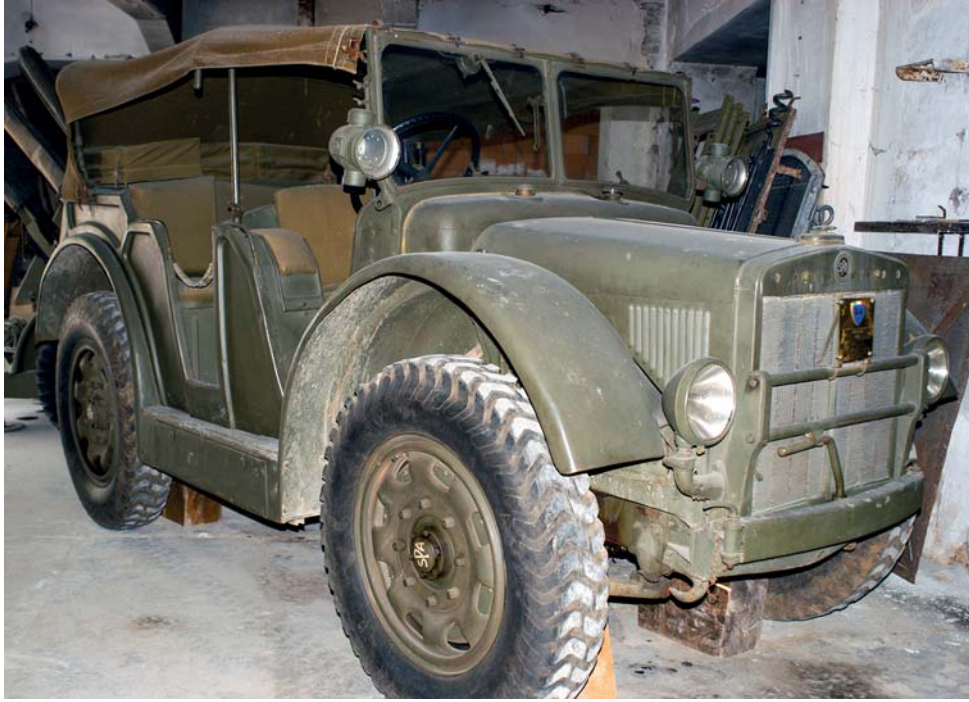
Fig. 5 - Il mezzo parcheggiato presso il deposito del Museo, munito di quattro ruote pneumatiche con pneumatico "Artiglio"; è poggiato su quattro plinti di legno per preservare i pneumatici stessi ed evitare che si affloschino sotto il peso del mezzo. Notare la capotina in tela cerata in posizione rialzata, che aiuta anche a proteggere il mezzo dalla polvere.
