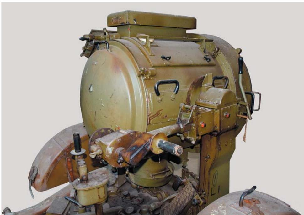
Fig. 8 - Dettaglio del sistema di elevazione della fotoelettrica.
