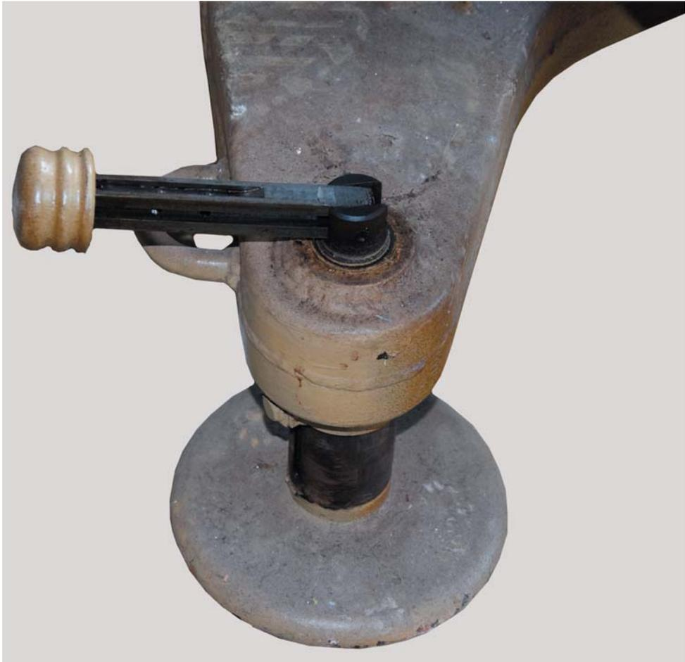
Fig. 12 - Dettaglio della manovella di posizionamento del cannone.
