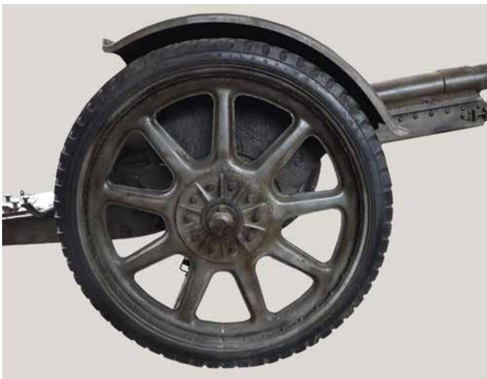
Fig. 6 - Le ruote in lamierino d'acciaio.
