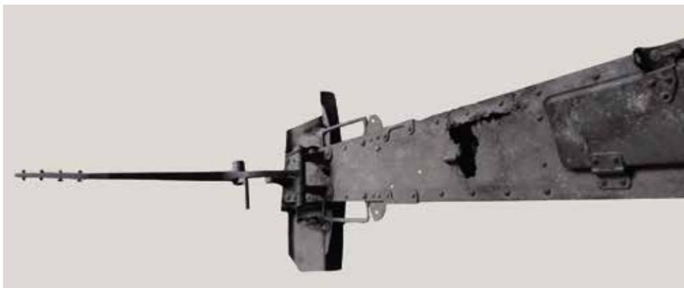
Fig. 10 - Particolare della coda con i danni provocati da ruggine.
