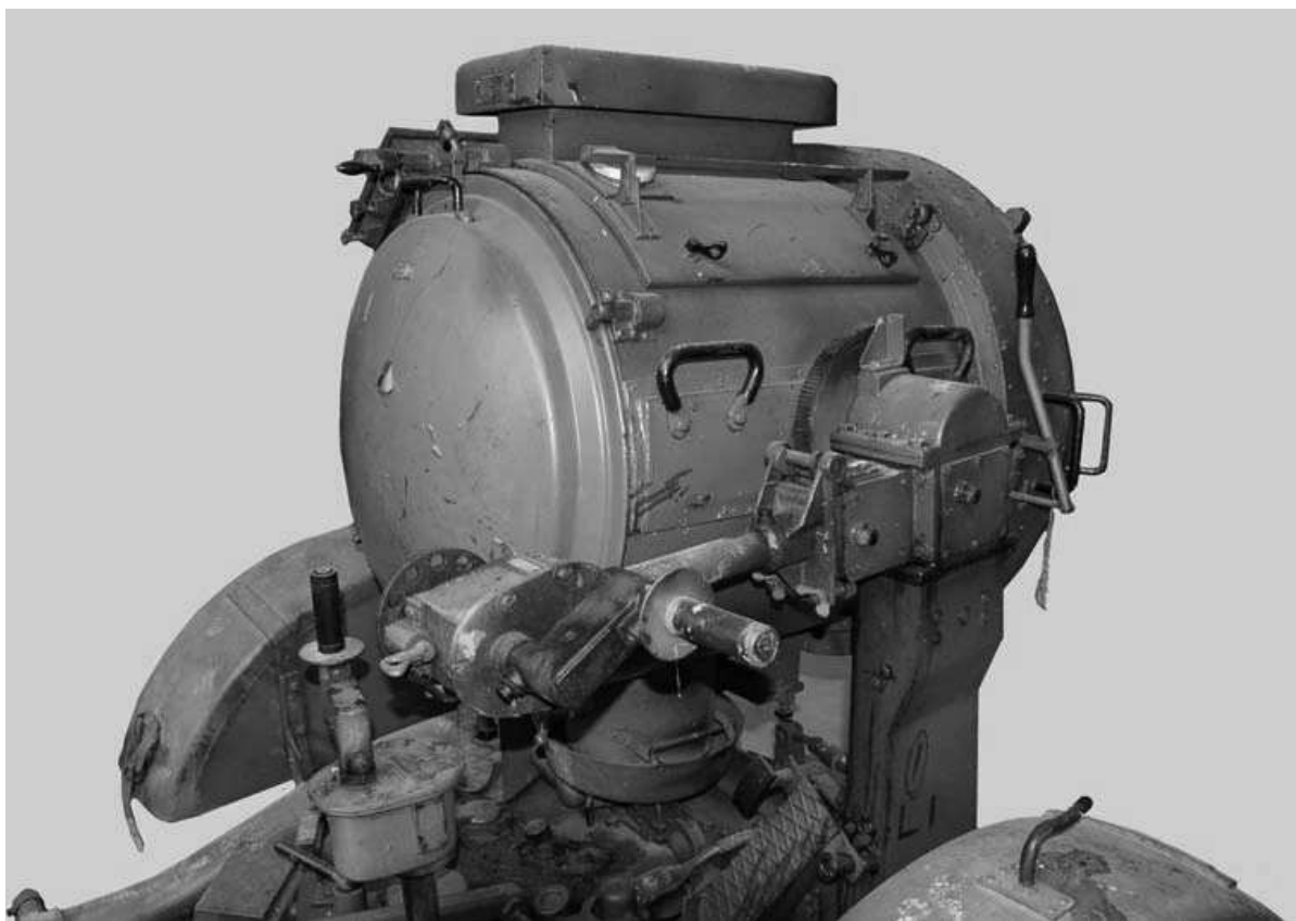
Fig. 8 - Dettaglio del sistema di elevazione della fotoelettrica.
