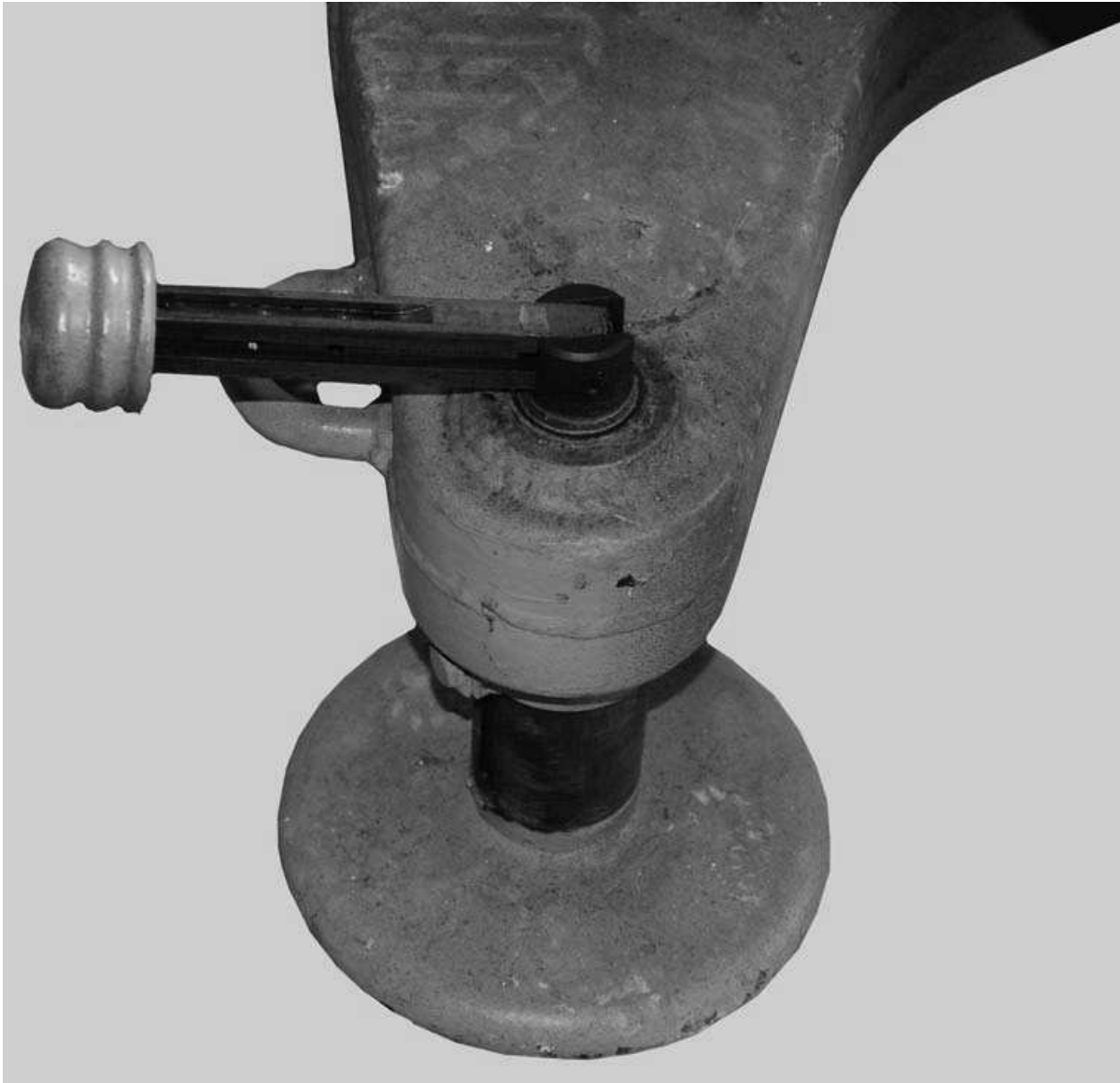
Fig. 12 - Dettaglio della manovella di posizionamento del cannone.
