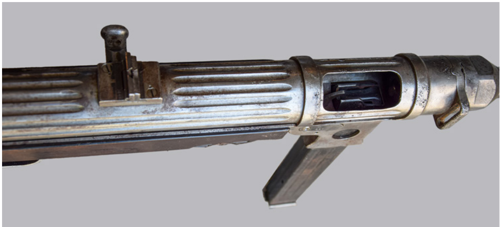
Dettaglio della finestra di espulsione dei bossoli di una MP38, con caricatore – vuoto – inserito e che mette in evidenza come tale soluzione tecnica favorisse l'ingresso di polvere e sporcizia in condizioni di combattimento (foto Luigi Carretta).
