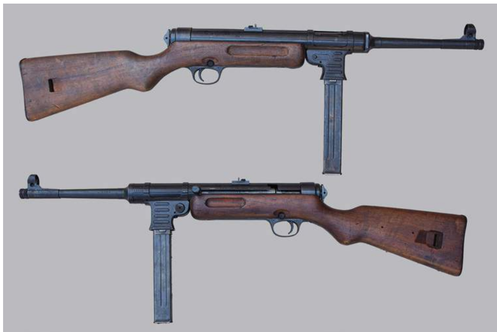
Un MP41 appartenente alla collezione del Museo della Guerra di Rovereto. Evidente la comunanza delle parti meccaniche con la MP38/40 (foto Luigi Carretta).
