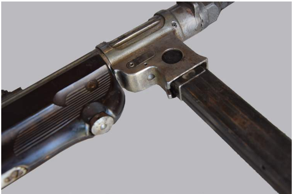
Dettaglio del bocchettone di alimentazione di una MP38 della collezione del Museo della Guerra di Rovereto (foto Luigi Carretta).
