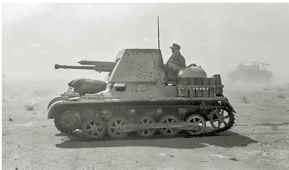
4,7 cm Panzerabwehrkanone 38(t) installato su cacciacarri Panzerjäger I, fronte nordafricano, 1941-1943. (Bundesarchiv Bild_101I-782-0041-31).
